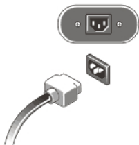
Figura 9. Conectarea la sursa de alimentare
